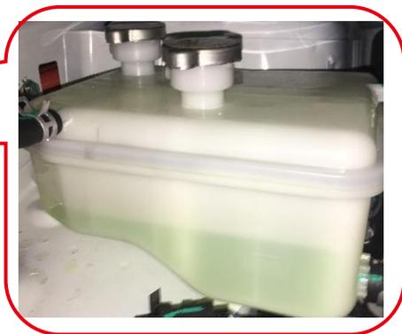
检查储液罐内冷却液的液位。如果储液罐中的冷却液液位在“MAX”（上限）和“MIN”（下限）标记线之间，则符合要求。如果液位低，须加注冷却液。
