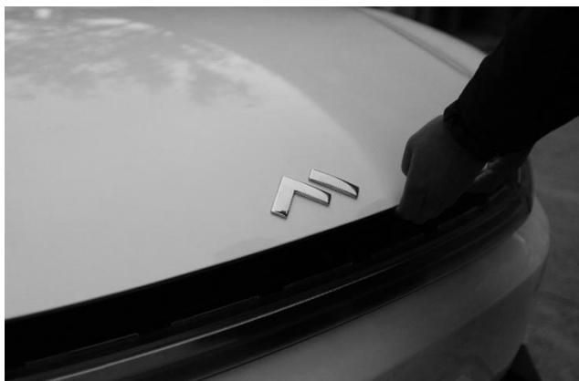
1. 取下撑杆并放置好，在距前舱盖板适当高度处，释放前舱盖即可。
