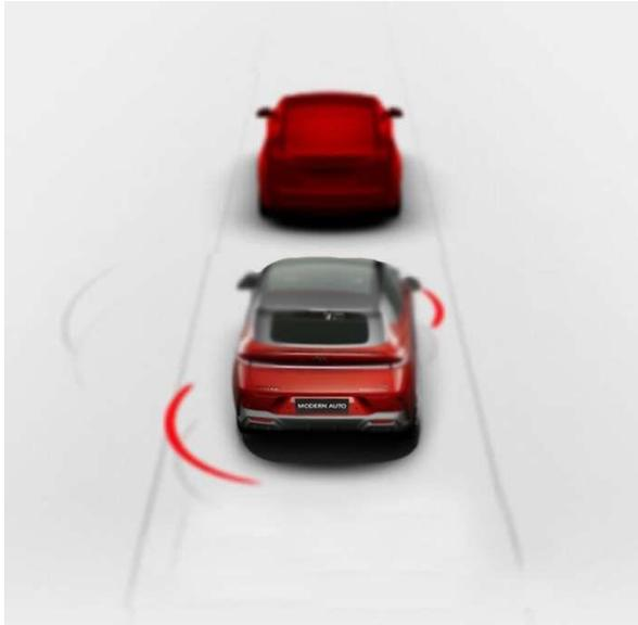
在碰撞风险降低后，警告自动取消（例如，车辆已减速或停驶，或车辆前方物体已离开车辆所在车道）。
