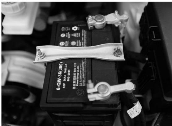
2. 将红色电缆的一端连接到亏电车辆A低压蓄电池的正极（+）上。
