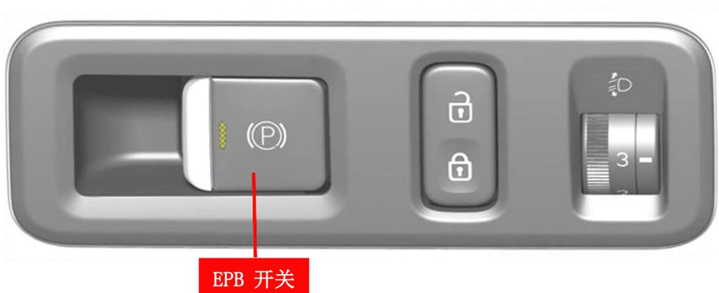
电子驻车制动器按钮位于方向盘左下方仪表台。驻车及离车时务必保证EPB处于拉起状态。
