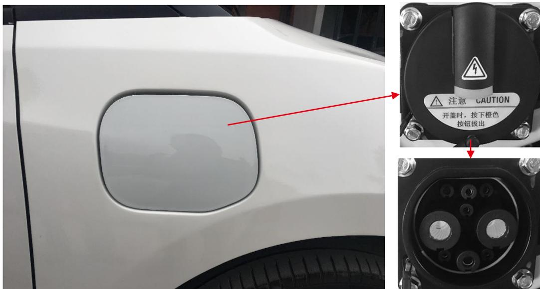
快充充电接口位于车辆右前方。用钥匙或中控锁解锁车门，然后按压快充充电口盖中间右侧，快充充电口盖弹出后，向上按压充电口盖以打开盖板。
