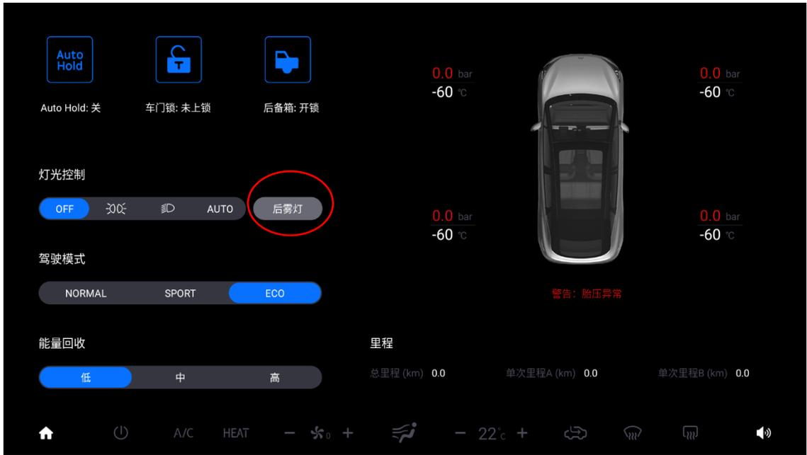
当启动开关位于ON位置，且前照灯开启时，按下后雾灯开关，可开启后雾灯。当后雾灯开启后，仪表上后雾灯指示灯点亮。
