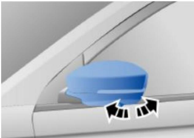
带电动折叠的车辆（精英版/尊享版）用智能钥匙解锁和锁止车辆，外后视镜分别会自动展开和自动折叠。
