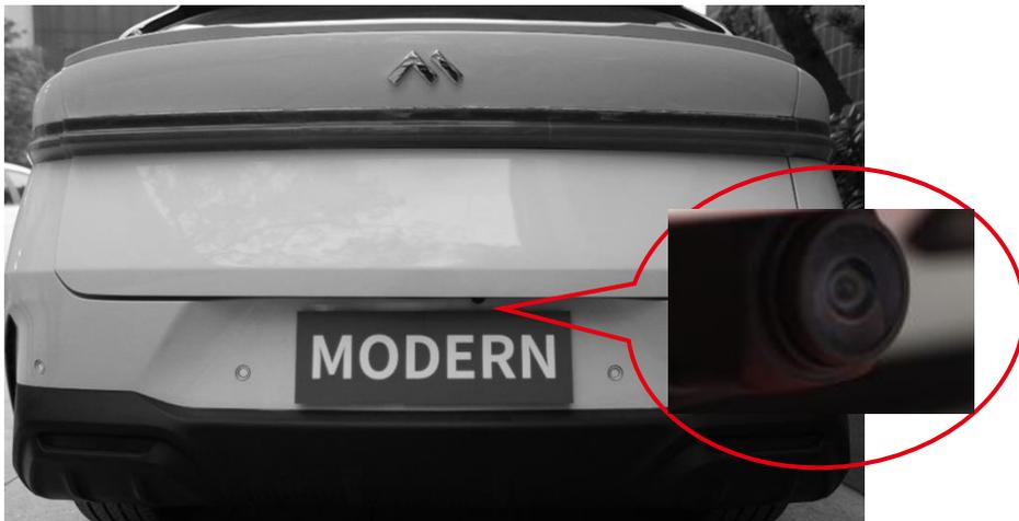
车辆倒车的摄像头位于后牌照板的上方，摄像头拍照的范围非常有限，不能够拍到角落附近或保险杠下的物体。显示的图像会因为车辆方向或道路状况而有所不同。出现在屏幕上的图像距离与实际距离是有差异的。
