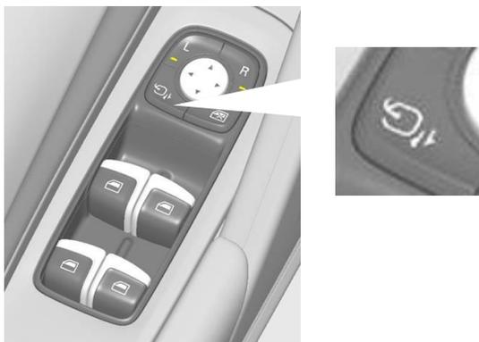
对于配备电动折叠外后视镜的车辆，按下按钮，外后视镜则会自动折叠，再次操作该旋钮，后视镜则回到原始位置。
