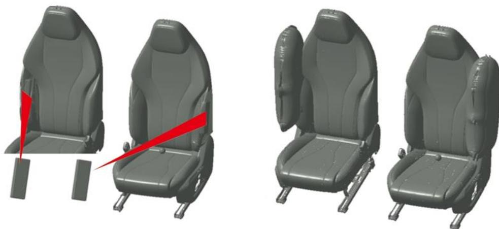
侧面安全气囊安装在前排座椅的靠背衬里，其安装位置上都标“**AIRBAG**”字样。在较严重的侧面碰撞事故中，可以对乘员的整个上身（胸部、腹部和胯部）提供额外的保护。
